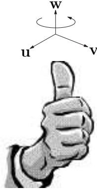
Figura 1.3: Regra da mão direita para determinar o sentido do produto vetorial \mathbf{w} = \mathbf{u} \times \mathbf{v} .
